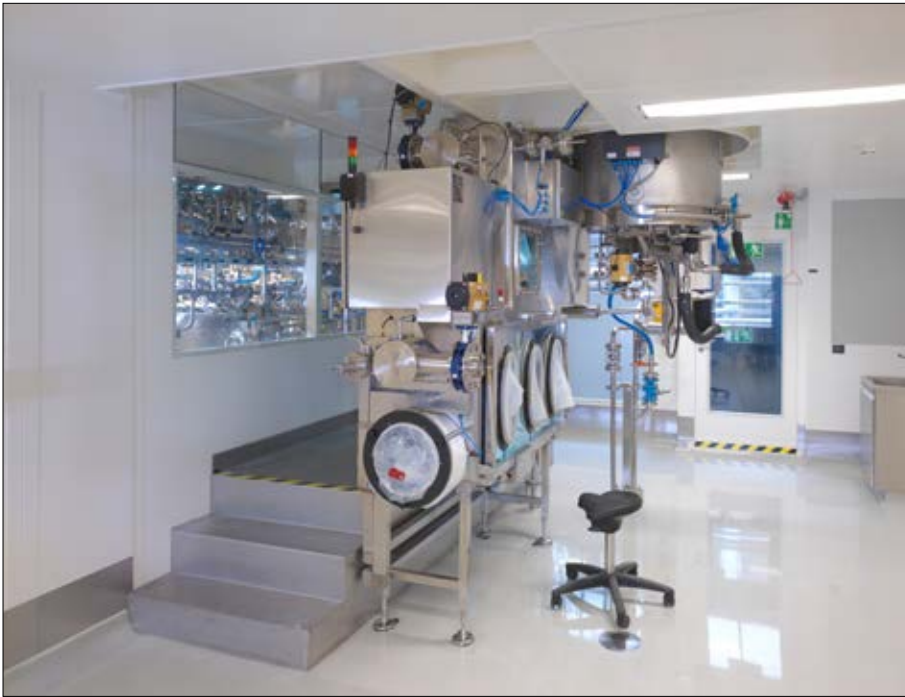
Filtertrockner-Entleerisolator zur Abnahme, Mahlen und Verpacken von pharmazeutischen Wirkstoffen (Bild: Dietrich Engineering Consultants AG)
