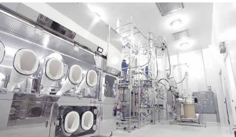
High-Containment-Pharmafertigung bei Kyongbo Pharm mit dem DCS-Drum-Containment-System
