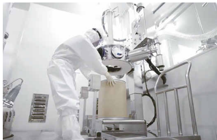
Kontaminationsfreie Probenahme von Rohmaterialien mit dem DCS
