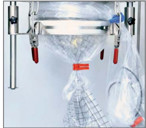
Abtrennen des gefüllten Big-Bags unterhalb des Dichtrings mit Hilfe eines Doppel-Clips.
