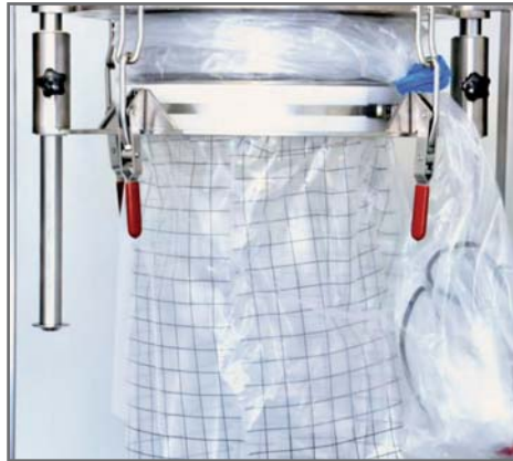
Abheben und Einspannen des Dichtrings an das Füllrohr. Das System ist nun bereit für den Produkttransfer.
