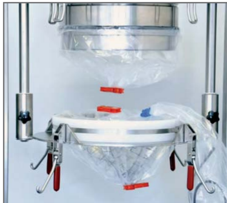
Ring lösen, senken und anschließende Trennung des Zwischenliners zwischen den beiden Clips.
