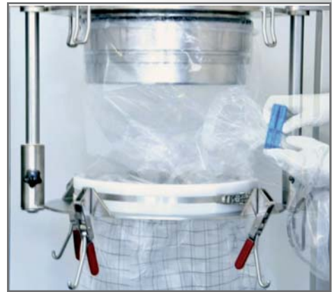
Anschluss des Zwischenliners an den oberen Teil des UniDock Systems. Entfernen des vorhergehenden Liners in seitliche Schutzhülse.
