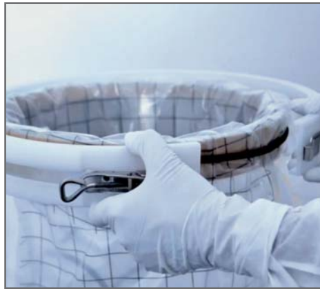
Befestigung des Big-Bags und des Zwischenliners mit einem O-Ring und einem Dichtring.
