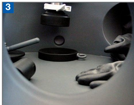
3 Einsetzen eines kleinen Trichters um Spritzer zu vermeiden
