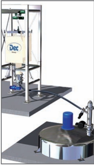
Big Bag Entleerstation mit Liner-Anschlussystem, Massage-Einheit, Klumpenbrecher und Wägesystem
