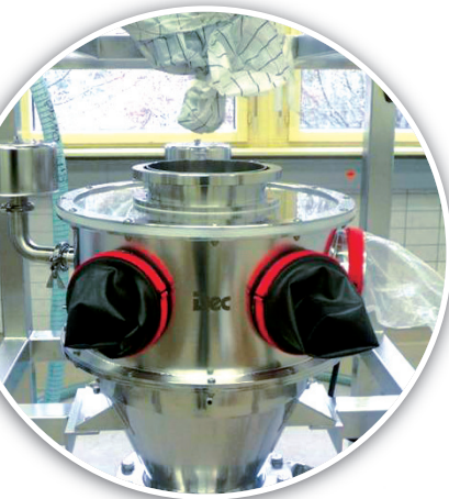
DCS-Dockingsystem für hohes Containment
