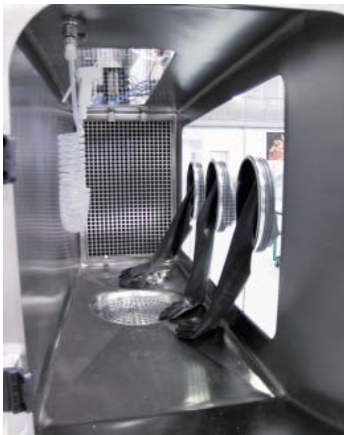
Im Innern der Hauptkammer des DEC Isocharge: Hybrides System von Isolator und Laminar-Flow-Kabine
